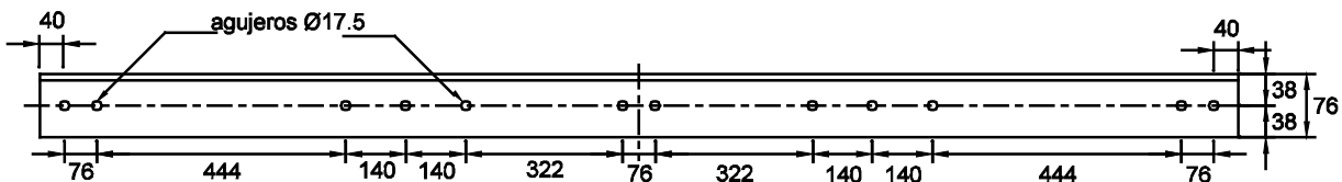
DETALLE 1 ( PERFIL ANGULAR DE 76 x 76 x 6.35 X 2400 mm)
